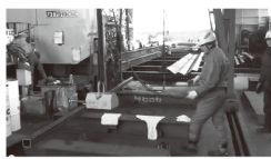
(2000kgのリフティングマグネットを用いています)
