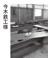
今木鉄工様 (600kgのリフティング マグネットを用いています)
